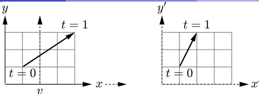
transformierte Koordinaten eines Objekts, das sich in einer Zeiteinheit von  $P = (1, 1)$  nach  $Q = (4, 3)$  bewegt ( $a = 3$ ,  $b = 2$ ) für  $v = 2$
