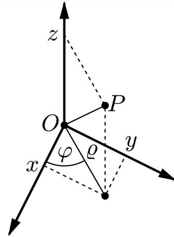
Der Winkel  $\varphi$  der Zylinderkoordinaten  $(\varrho, \varphi, z)$  ist nur bis auf ein Vielfaches von  $2\pi$  bestimmt. Als Standardbereich wird meist  $\varphi \in (-\pi, \pi]$  vereinbart.
