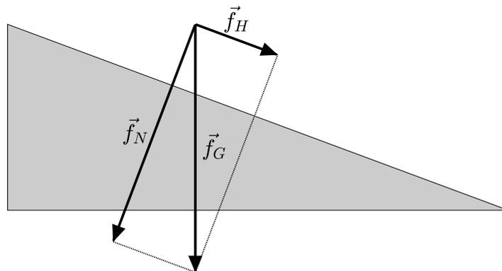
Projektion von  $\vec{f}_G$  auf eine zur Ebene parallele und orthogonale Richtung
