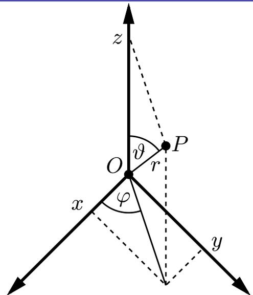
Der Winkel  $\varphi$  der Kugelkoordinaten  $(r, \vartheta, \varphi)$  ist nur bis auf ein Vielfaches von  $2\pi$  bestimmt. Als Standardbereich wird meist  $\varphi \in (-\pi, \pi]$  vereinbart. Für  $x = y = 0$  (Punkt auf der  $z$ -Achse) ist  $\varphi$  beliebig und, falls ebenfalls  $z = 0$ , so auch  $\vartheta$ . In diesen Fällen kann Null als kanonischer Wert gewählt werden.
